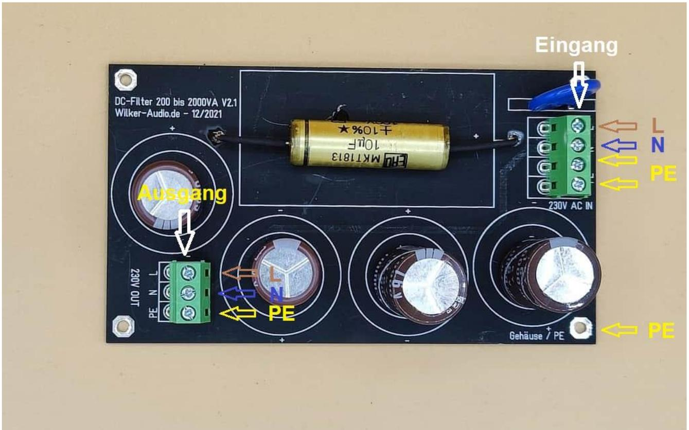
Diese Platine wurde für einen Kunden designed, der spezielle High End Bauteile verwendet haben wollte. Daher sind die Abmessungen etwas größer: 126mm x 71mm
